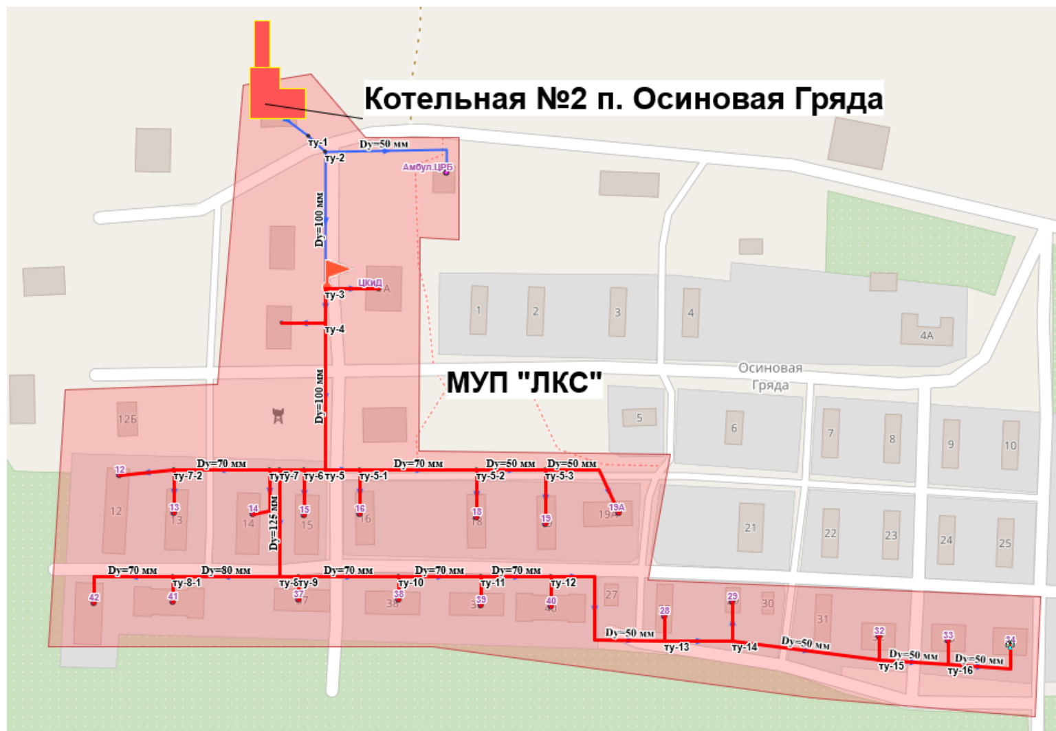
Рисунок 15. Визуализация отключения запорной арматуры от ТУ-2 до ТУ-3 (Котельная № 2 п. Осиновая гряда, МУП «ЛКС»)
