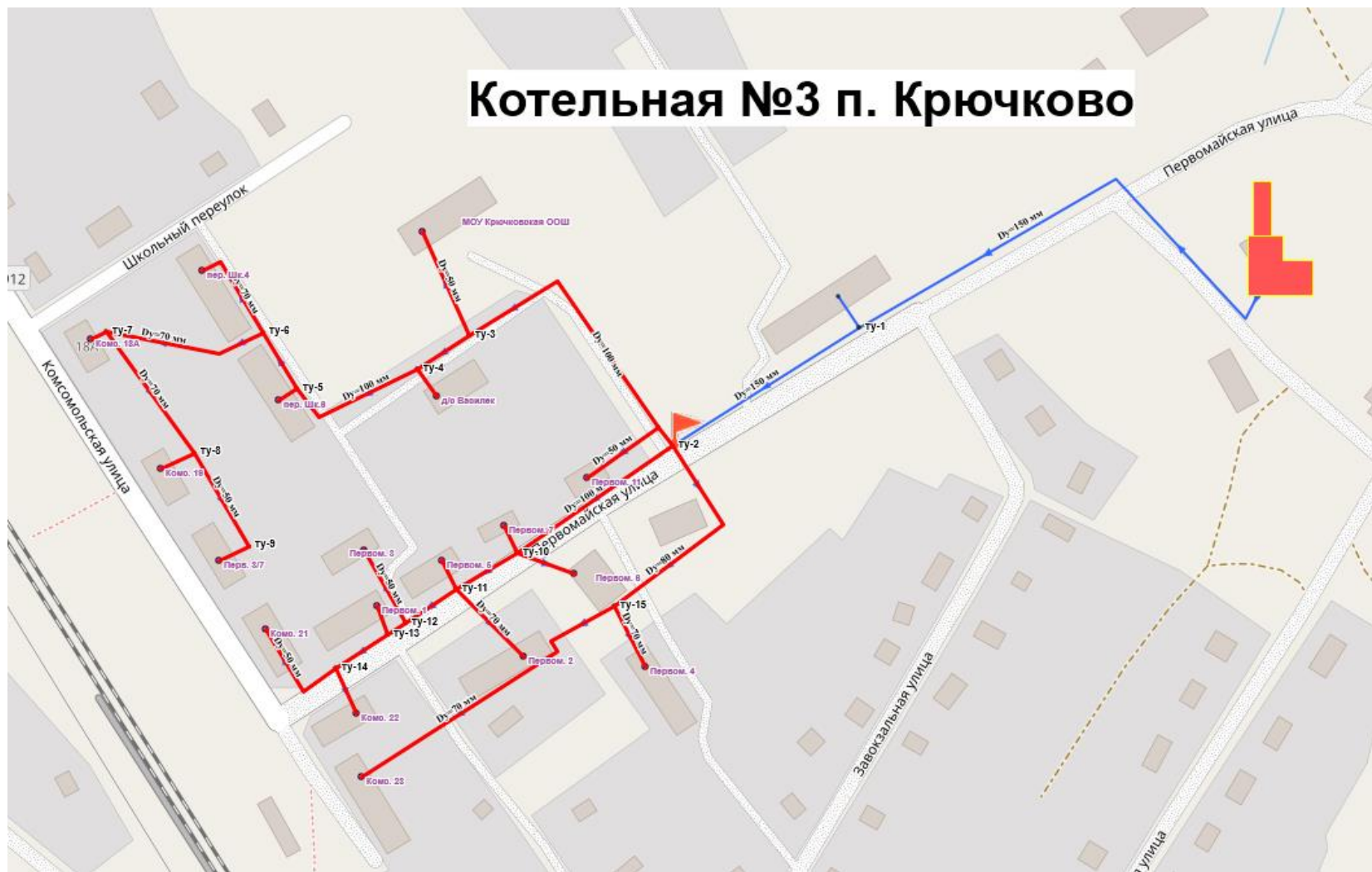
Рисунок 17. Визуализация отключения запорной арматуры от ТУ-1 до ТУ-2 (Котельная п. Крючково, МУП «ЛКС»)
